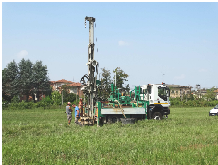
Fig. 8: Realizzazione del sondaggio S2 con vista delle aree interessate dalla realizzazione della vasca
